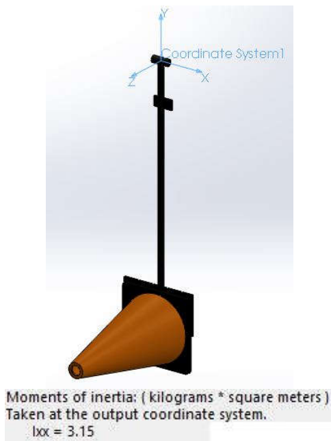
Gambar 7. Perhitungan momen inersia menggunakan software Solidworks.
