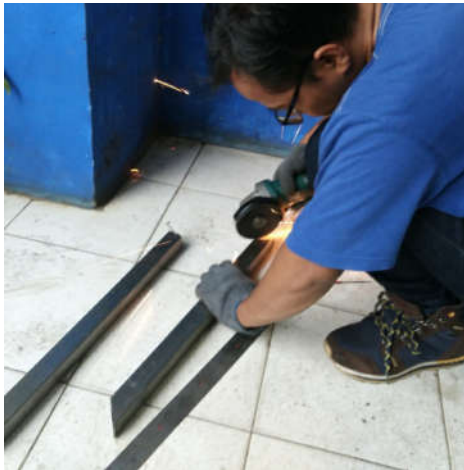
Gambar 23. Proses pemotongan material besi pipa kotak
