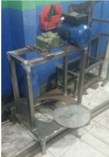
Gambar 27. Pemasangan komponen motor listrik
