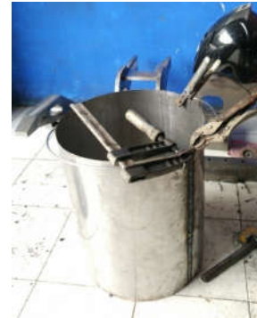
Gambar 28. pengelasan pada panci pengaduk
