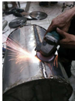
Gambar 29. Penghalusan pada permukaan sambungan lasan panci
