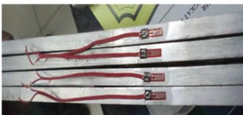
**Gambar 4.** Pemasangan strain gauge pada balok
