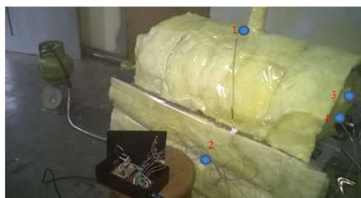
**Gambar 1.** Posisi peletakan termokopel K
