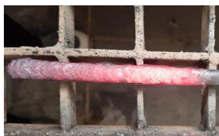
Gambar 2. Spesimen Pasca Pengelasan HV 350
