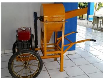
**Gambar 1.** Mesin Pencacah Pelepah Sawit Sistem Rotary
