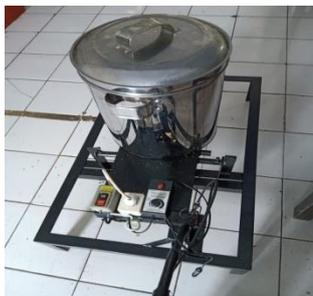
Gambar 9. Hasil Akhir Pembuatan *Machine Oil Drainer*
