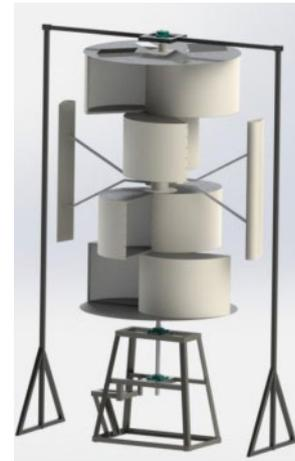
Gambar 2. Konstruksi Savonius 4 tingkat [9]
