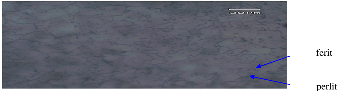
Gambar 13. Foto Struktur mikro pada daerah bending
