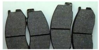
Gambar 3. Kampas Rem Berbahan Baku Non Asbestos<sub>[2]</sub>
