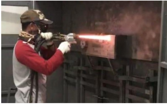
Gambar 3. Proses penyemprotan HVOF thermal spray
