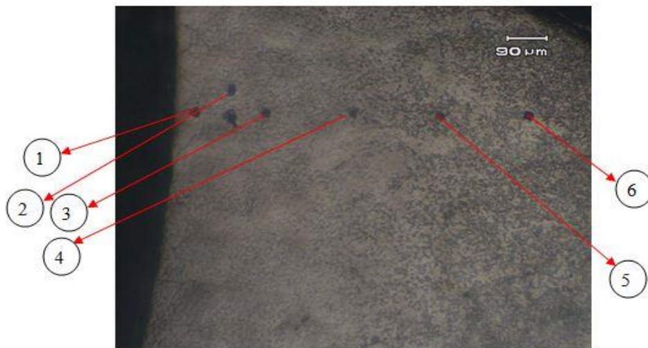
Gambar 4. Titik Penekanan Pada Sampel Gear Sprocket Racing
