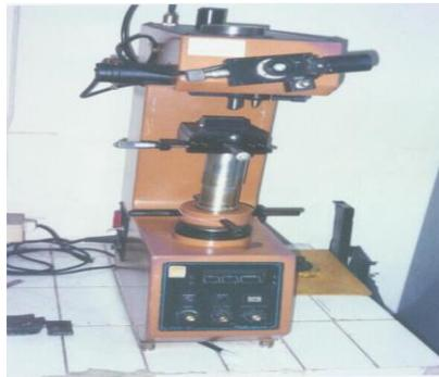
**Gambar 2. Foto mesin uji Vickers.**
