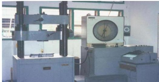
**Gambar 1. Foto Mesin uji tarik Universal**
