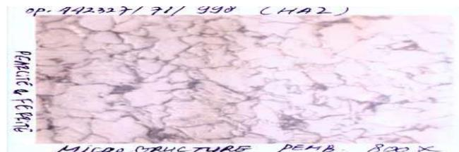
**Gambar 10. Struktur Mikro daerah HAZ**
